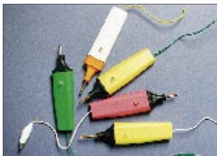
Bild 2: Ausgediente Textmarker bilden geeignete Gehäuse für Durchgangs- und Polprüfer.
