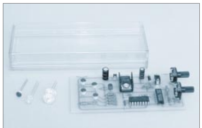
Bild 4: Im Mustergerät wurden Multichip-LEDs eingesetzt
