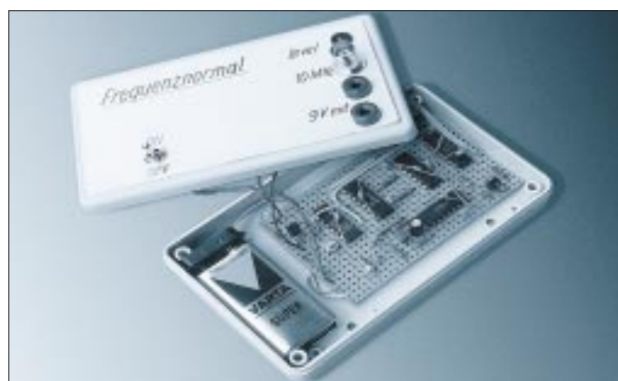
Bild 8: Ansicht des Musteraufbaus des vielseitigen Frequenznormals
